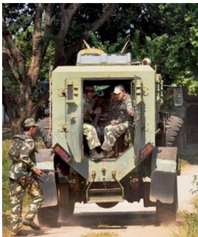
Des forces spéciales 'anti-naxal', leur véhicule de contre-guérilla a un châssis blindé en forme de 'V' détournant l'effet de souffle lors de l'explosion d'une mine.
